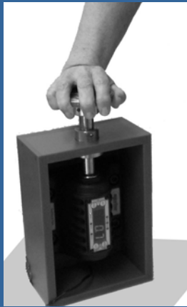
Messung von Drehkräften beim Öffnen von Schraubverschlüssen
