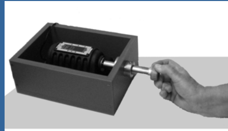
Messung von Drehkräften beim Öffnen von Schraubverschlüssen
